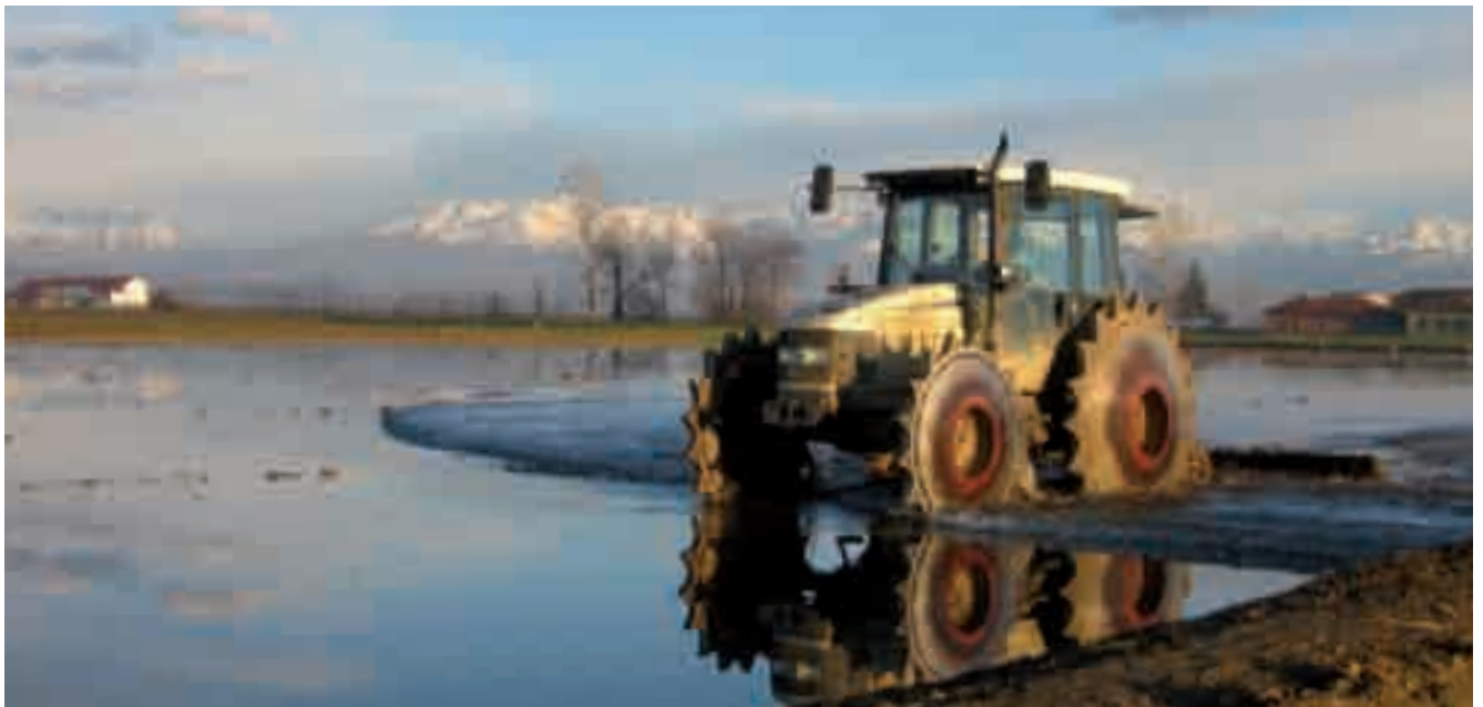
Trattrice equipaggiata con ruote dentate per le lavorazioni in acqua
